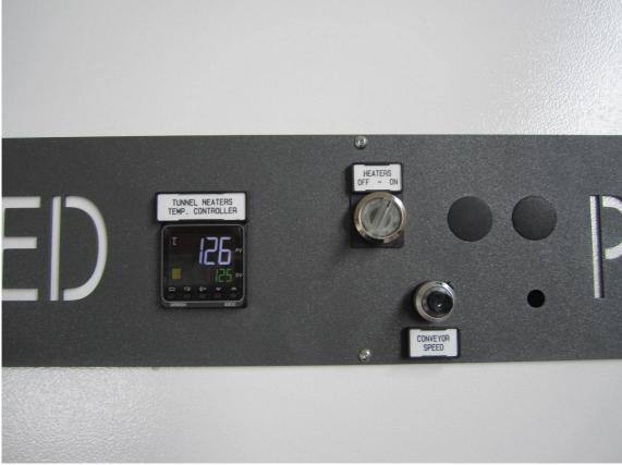
HEATERS ON OFF-SWITCH ON OR OFF TUNNEL'S TEMPERATURE CONTROL TUNNEL'S CONVEYOR SPEED
